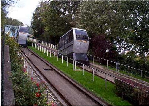
Le funiculaire est un moyen de transport en commun, guidé sur des rails rectilignes, et se déplaçant sur des distances relativement courtes mais très raides. L'entraînement est réalisé par un treuil situé dans la gare supérieure, enroulant un câble lié à la cabine du funiculaire, il permet ainsi de gravir la pente depuis la sortie de la station de métro jusqu'en haut de la butte Montmartre.
